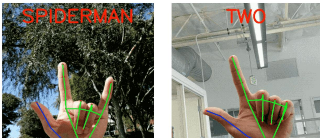
Рис. 1.2. Приклад роботи Mediapipe
