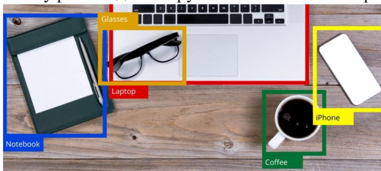
Рисунок 3.7 - Приклад результату роботи детектору YOLO
