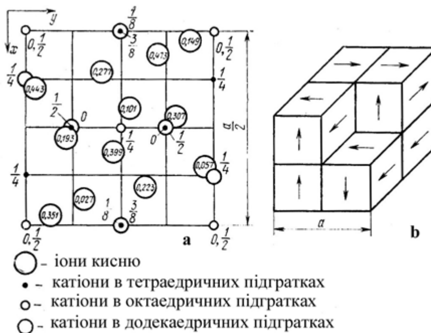
Рис.1.2 Розміщення іонів кисню в залізо-ітрієвому гранаті
