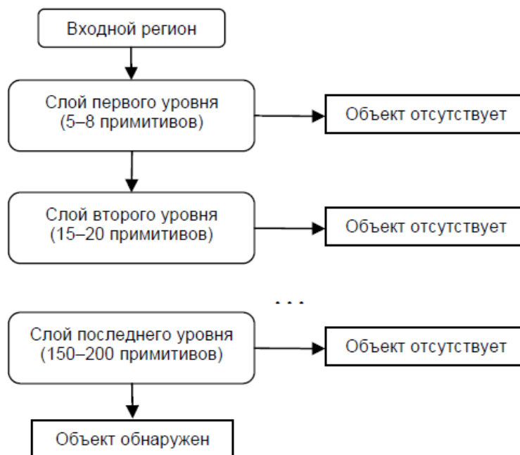
Рисунок 2.4 – Приклад каскадної моделі сильних класифікаторів
