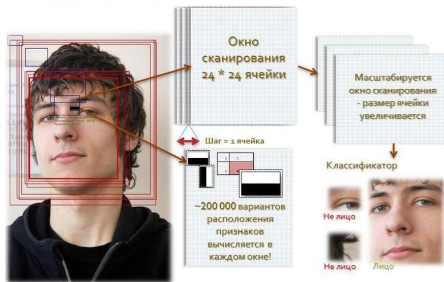
Рисунок 2.2 – Візуалізація алгоритму скануючого вікна
