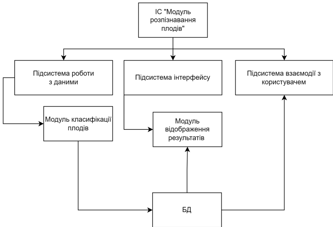
Рис. 3.1.Схема взаємодії підсистем з базою даних для формування веб-сторінки з результатами
