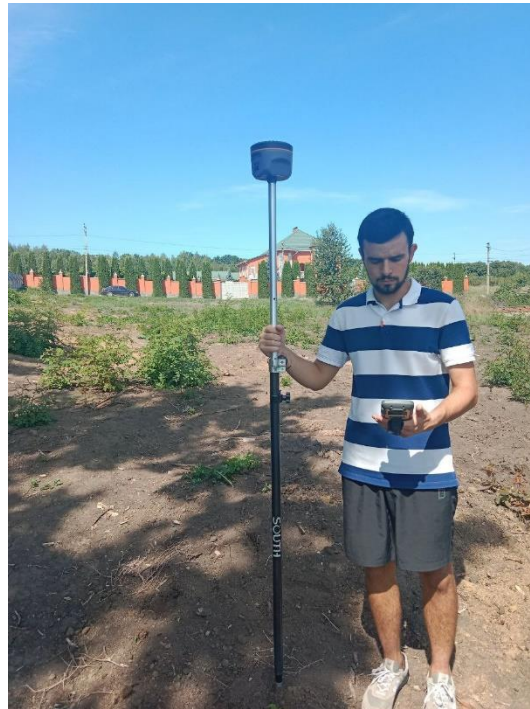
Рис. 3.1 Вимірювання земельної ділянки за допомогою GNSS-приймача
