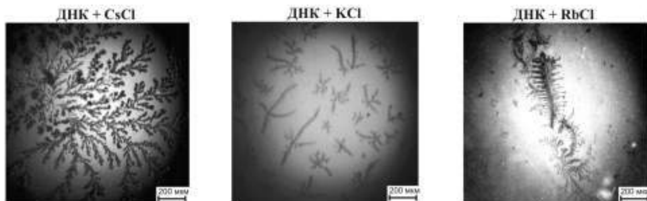
Рис. 4.2. Текстури плівок ДНК із надлишком солей CsCl (30 ммоль/л), KCl (5 ммоль/л) та RbCl (5 ммоль/л). Концентрація ДНК у вихідному розчині становить 0,2 мг/мл. Рисунок з роботи дисертанта [67].
