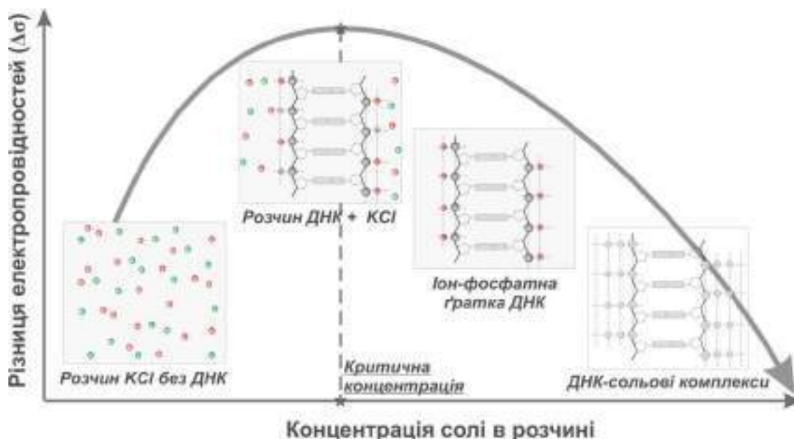
Рис. 4.11. Схематичне зображення залежності різниці електропровідностей водного розчину KCl з ДНК і без ДНК та ілюстрація процесу іонного впорядкування навколо подвійної спіралі при збільшенні концентрації солі.
