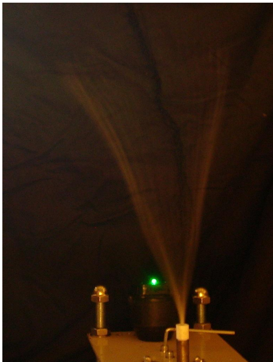
Рис. 2.7. Перехідні коливання між третьою формою та стабілізацією
