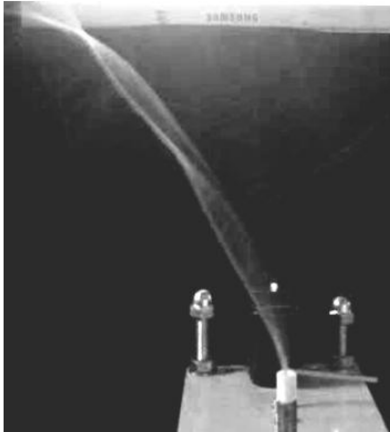
Рис. 4.2. Одночасне коливання по другій і третій формам
