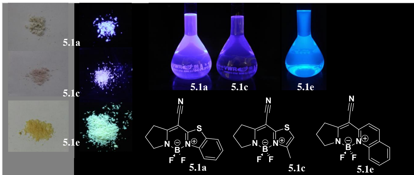
Рис. 5.6. Фотографії аморфних порошків BF_2 -фіксованих комплексів 5.1a,c,e (ліворуч), опромінення порошків та розчинів (розчинник CHCl_3 ) УФ лампою (праворуч), \lambda_{ex}=365 нм.
