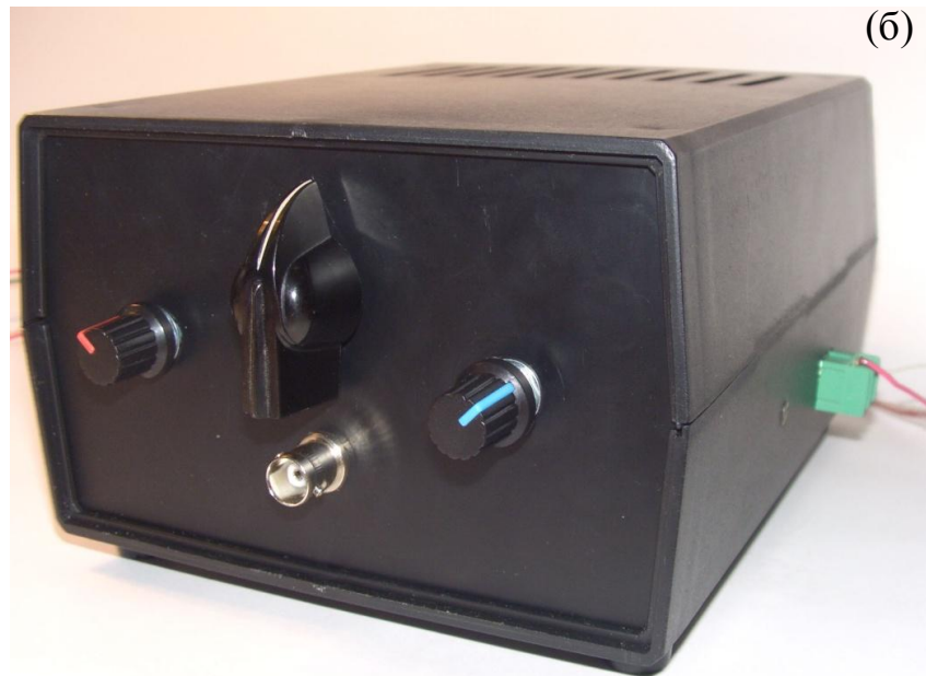
Рис. 2.5. Зображення друкованої плати стабілізатора струму S10-C (а) та зовнішній вигляд приладу (б).
