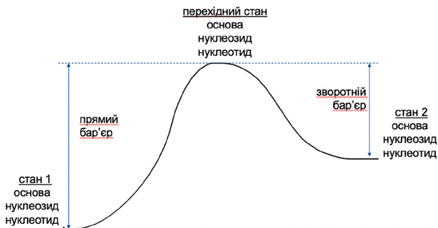
Рис. 3.7. Схематичне зображення предметів дослідження: прямого та зворотнього бар'єрів
