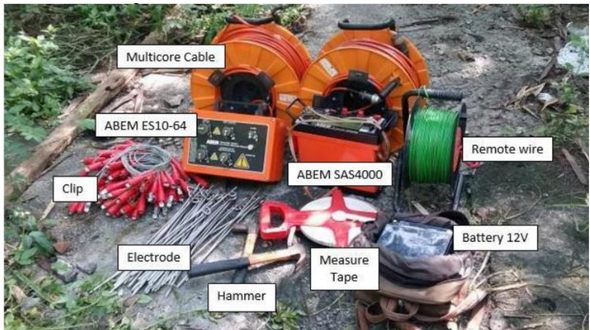
Рис.3.6 Приклад всіх складових для вимірювання опору методом ERT (N.Akhtar, M.S.Mislan, M.I.Syakir, M.T.Anees, M.S.M. Yusuff, 2021)
