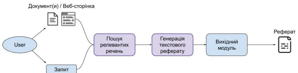
Рис. 2.2 Головна ідея запропонованого алгоритму для реферування тексту за допомогою запиту
