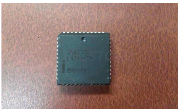
Рисунок 1.5 – Контролер 82526 створений компанією Intel
