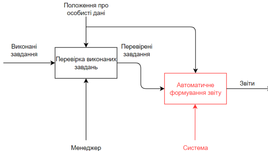
Рисунок 2.7 - Декомпозиція діаграми ЯК БУДЕ процесу «Відстеження» в нотатції IDEF0
