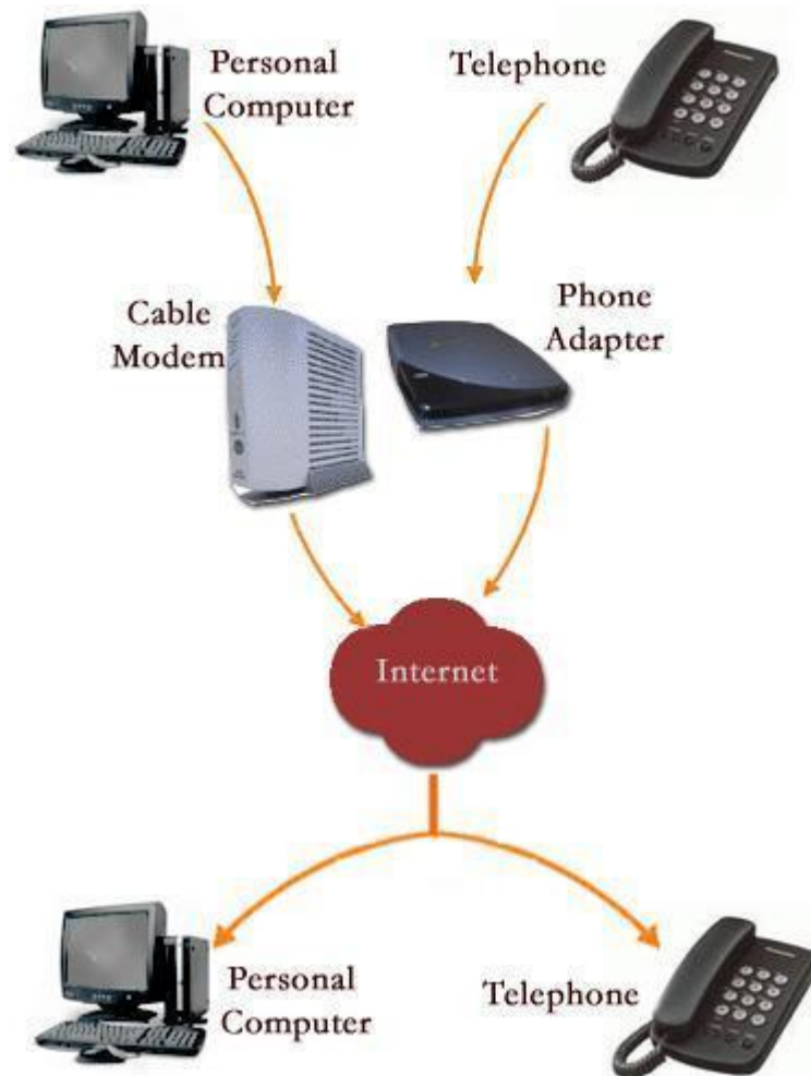
Рисунок 1.11 – Схема мережі девайсів, яка реалізує протокол VoIP [10]
